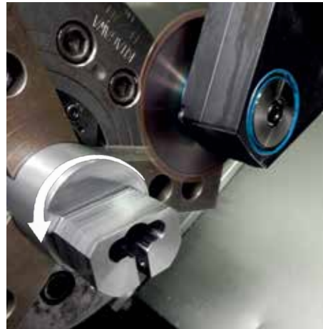
Turn Cut Milling : steel 16MnCrS5 Vc = 160 m/min Fz = 0,05 mm bei 40 Zähnen
